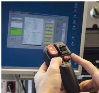
Test funzionale su joystick elettronico presso il reparto Elettronica Walvoil
